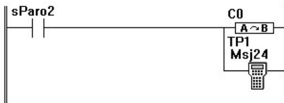
Блок копирования передает содержимое счетчика C0 автомата в параметр 1 TP-10. Блок Msj24 дает команду TP-10 отобразить сообщение 24 с соответствующим значением параметра 1.
