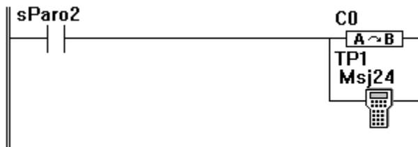
Der Kopierblock überträgt den Inhalt des Zählers C0 der PLC auf den Parameter 1 des TP-10. Der Block Msj24 weist dem TP-10 an, dass es die Meldung 24 mit dem Wert des geeigneten Parameters 1 anzeigen soll.
