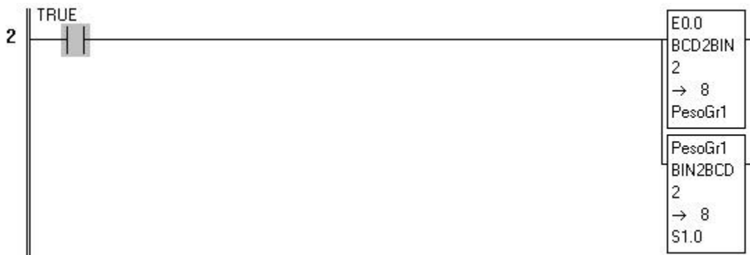
Figura 42: Ejemplo bobina numérica 1/2
