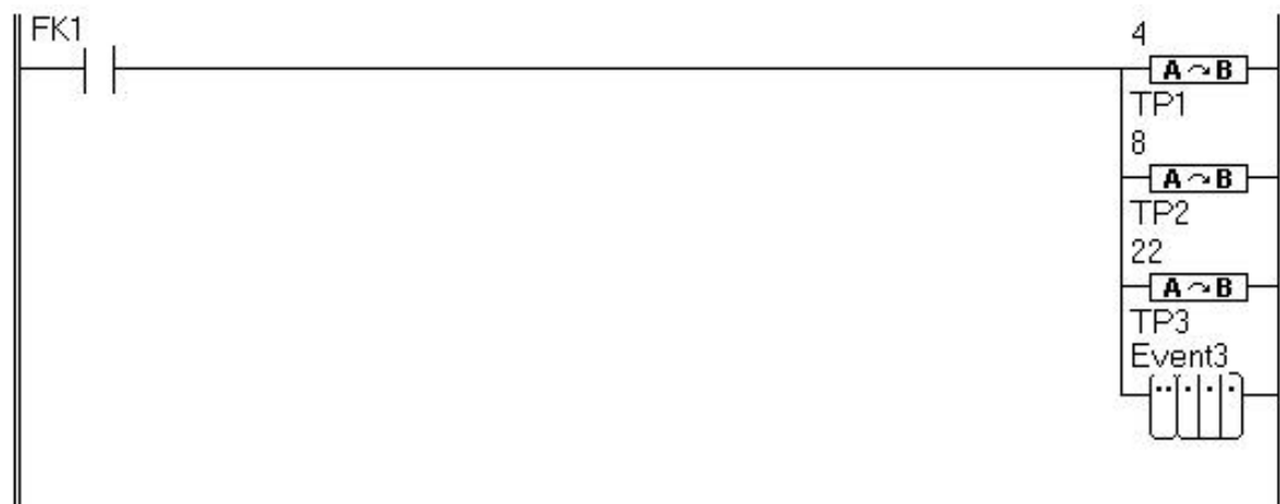
Figura 44: Ejemplo bobina de evento. Programa PLC
