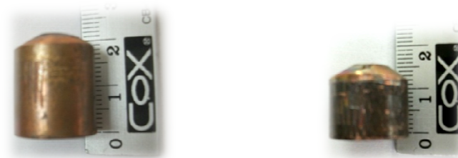
Fig. 2-5: Electrodos ISO5821-F16-5,5 en 'Inicial' y 'Final' condiciones de fresado
